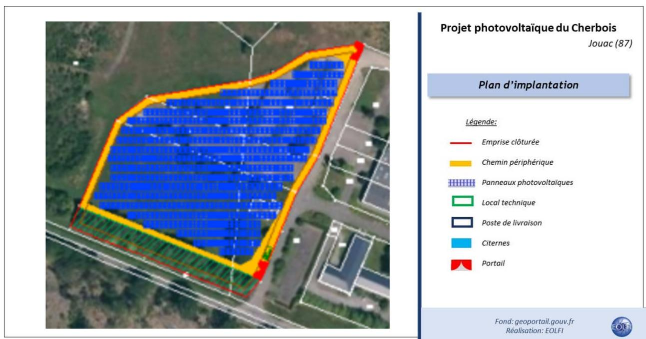
Figure 7 : Schéma d'implantation de la centrale photovoltaïque ouest
