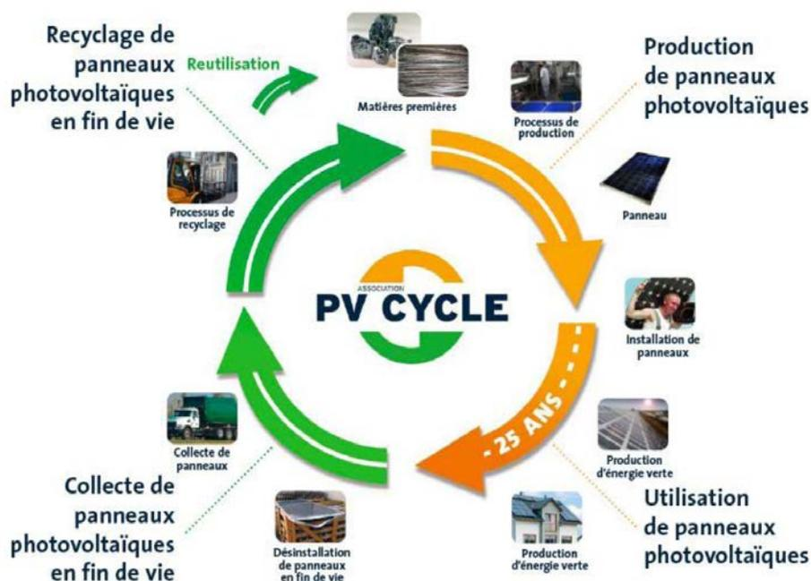
Figure 27 : Analyse du cycle de vie des panneaux photovoltaïques (source : PV Cycle)
